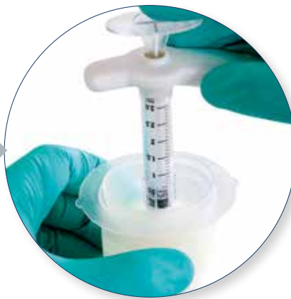
Podłączenie strzykawki do złącza typu Luer we wkładzie do przenoszenia*
